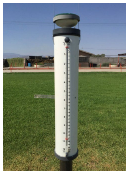
Figura 5. Atmómetro, equipo para detectar la evapotranspiración de referencia
