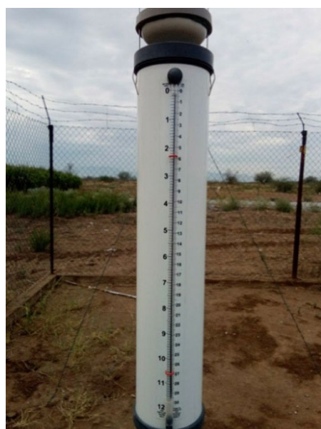
Figura 5. Atmómetro, equipo para detectar la evapotranspiración de referencia
